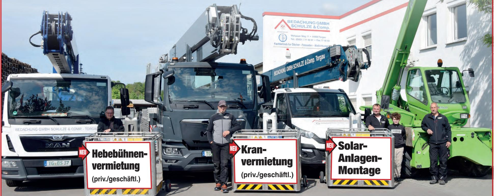
Die Kranlogistik der Firma Bedachung GmbH Schulze & Comp. aus dem Welsauer Weg 11 in Torgau ist modern und kommt bei vielen Aufträgen für die öffentliche Hand zum Einsatz. Die Kräne im Einzelnen (v. l.): MAN-AMAK 75 E bis 3 t, maximale Höhe 34 m; MAN-AMAK 170 E bis 5 t, maximale Höhe 41 m; IVECO-AMAK 60 E bis 1,6 t, maximale Höhe 32 m und ein Frontlader. Foto: HL
