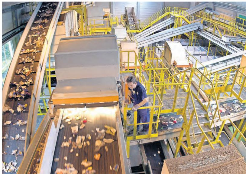
Foto: Wolfgang Zeyen Wenn Leichtverpackungen in den gelben Tonnen vorsortiert ankommen, entstehen zu über 50 Prozent neue Rohstoffe.
