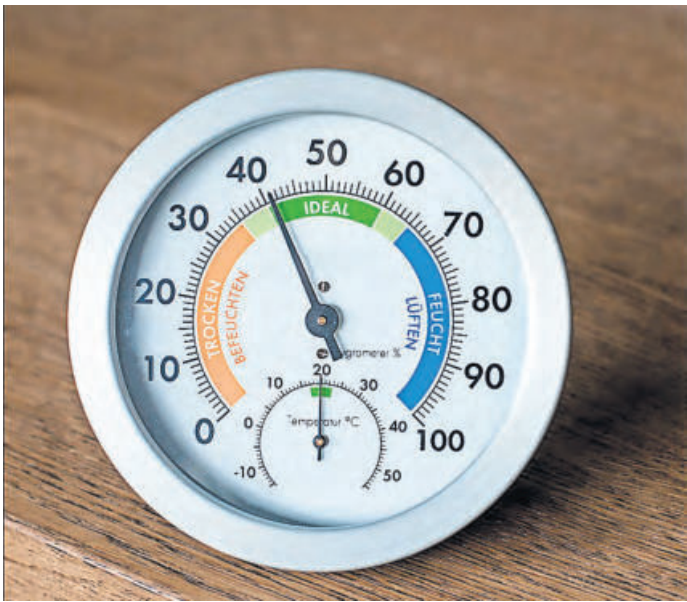
Ein Hygrometer hilft, die Luftfeuchtigkeit in Haus/Wohnung im Blick zu behalten und kann Schäden an der Gesundheit oder Bausubstanz vorbeugen. Foto: kanzantsvea/123rf/vzbw
