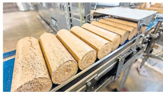
Aus Sägespänen werden Briketts bei Mercer Torgau.
