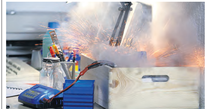
Beim Laden ist eine Akkuzelle in Brand geraten. Foto: Institut für Schadenverhütung und Schadenforschung der öffentlichen Versicherer
