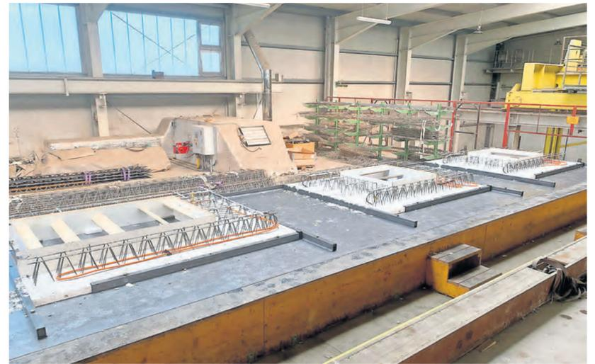
Projekt 2b T+SFLC-Module Halbfertigteile mit thermischer Aktivierung
