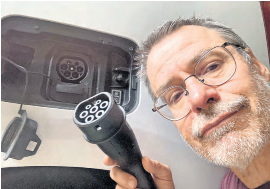
Zapfpistole ist out. Wer ein E-Auto fährt, wie Redakteur Hagen Rösner, der benötigt einen Typ-2-Stecker, um Ladesäulen unterwegs nutzen zu können. Das Ladestellennetz in der Region um Leipzig ist in den vergangenen Monaten gut ausgebaut worden. Foto: privat
