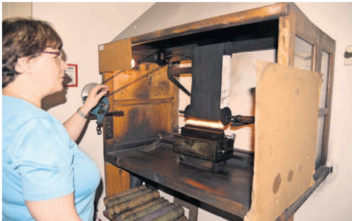
Petra Buchholz bereitet im Geophysikalisches Observatorium Collm das Papier für den 123 Jahre alten Wiechert-Seismografen vor. Dieses wird manuell berußt. Fotos: Kristin Engel
