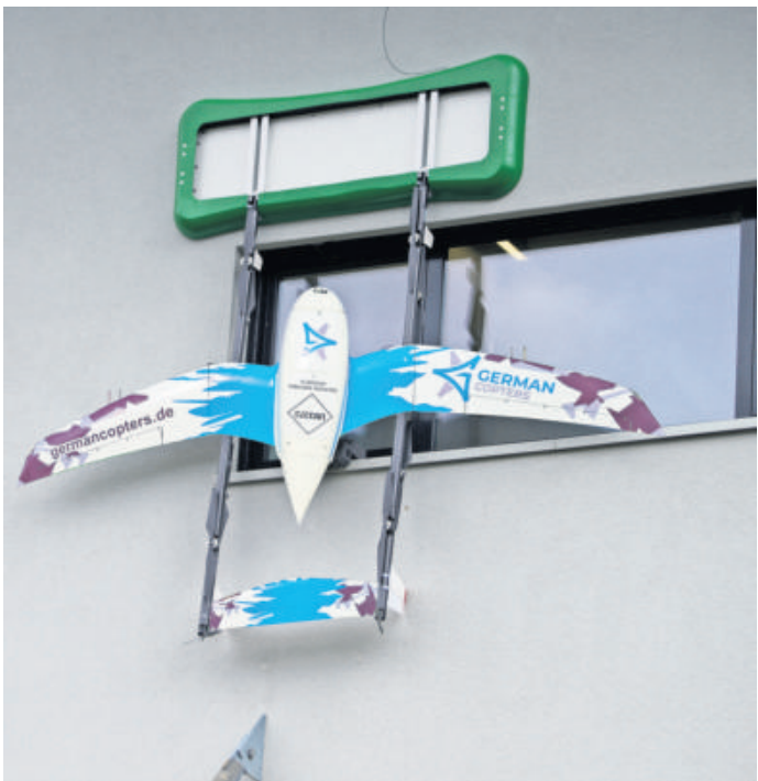
Die Drohne klinkt an einer speziellen Vorrichtung am Fenster ein und kann dann direkt mit den Proben für das Labor bestückt werden. Foto: German Copters DLS GmbH
