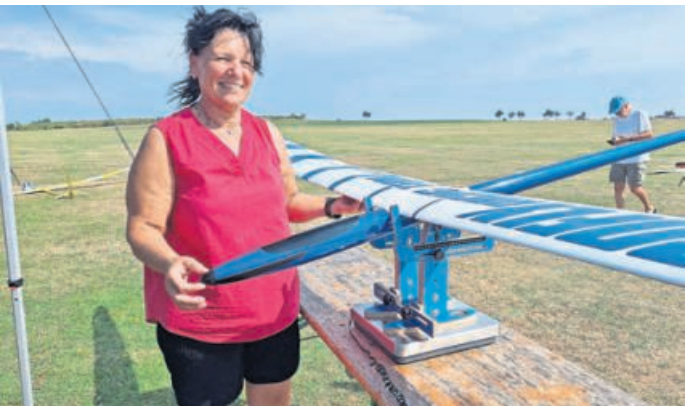
An der sogenannten Schwerpunktwaage wird geprüft, ob auch kein Fluggerät das zulässige Maximalgewicht von sieben Kilogramm überschreitet, erklärt Wettbewerbsleiterin Marianne aus Aschaffenburg.
